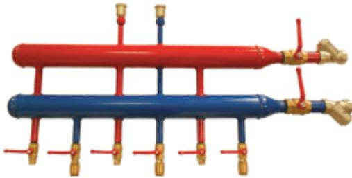
Распределительные коллекторы отопления предназначены для разделения потока теплоносителя от контура нагревателя (котла) между контурами потребителей. С полным термогидравлическим разделением подающей и обратной линией. Состоят из 2-х цилиндрических труб – подающей и обратной линии. Коллекторы используются для подсоединения трех контуров теплоносителя.
