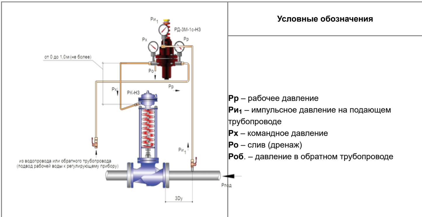
Схема регулирования давления «до себя» состоит из регулятора РД-3М-1с-НЗ (односильфонный с нормально закрытым управляющим клапаном) и нормально закрытого регулирующего клапана РК-НЗ. При увеличении давления  $P_{и1}$  от заданного равновесие в импульсной камере РД-3М нарушается и подается командное давление  $P_x$ , которое при помощи мембранного привода РК-НЗ поднимает плунжер и уменьшает давление системы до установленной (настроенной) в РД-3М величины.
