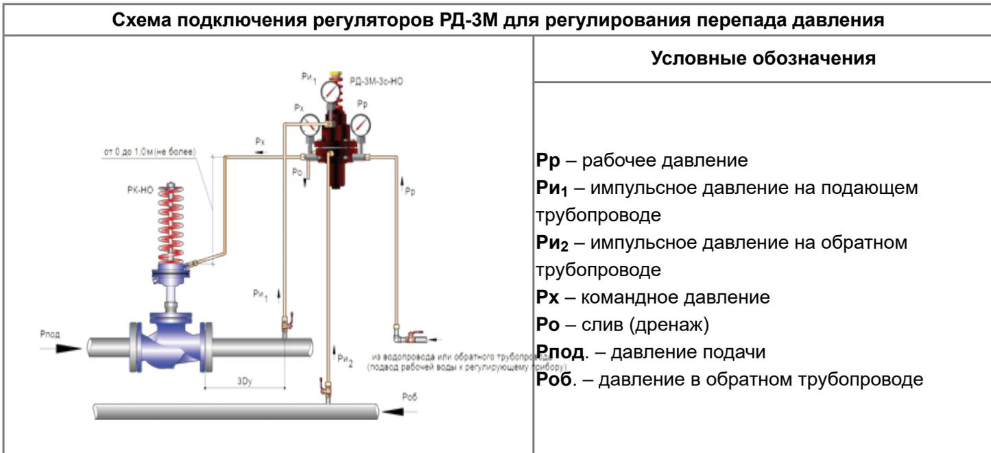
Схема регулирования перепада давления состоит из регулятора РД-3М-3с-НО (трехсильфонный с нормально открытым управляющим клапаном) и нормально открытого клапана РК-НО.
