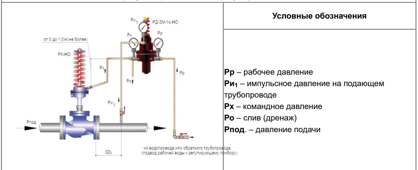
Схема регулирования давления «после себя» состоит из регулятора РД-3М-1с-НО (односильфонный с нормально открытым управляющим клапаном) и нормально открытого регулирующего клапана РК-НО. Давление из точки  $P_{и1}$  поступает в импульсную камеру регулятора РД-3М, где управляющий клапан задает давление  $P_x$  на гидропривод клапана РК-НО.
